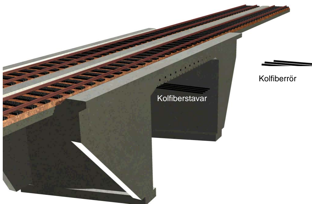
Figur 5.50 Principiell förstärkning av brofärdplatta
