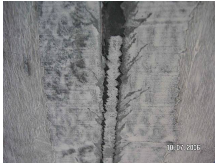
Figur 5.44 Foto av kolfiberstång efter brott.
